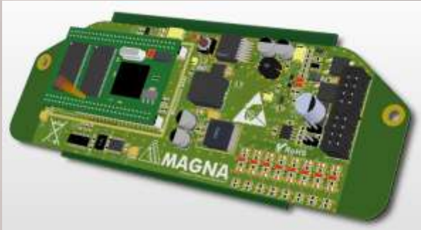
Carte CPU ARM9/Linux 400MHz avec interface CAN, TOR et LCD graphique.
